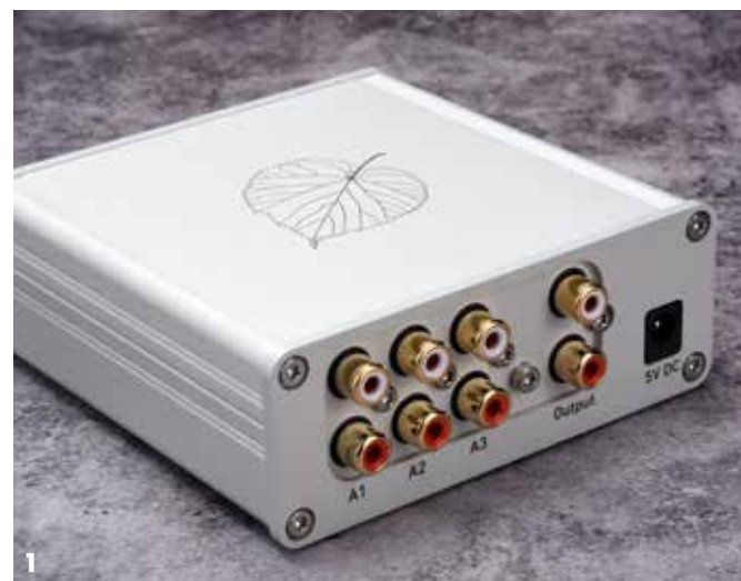
1 HEADPHONE的背板有三組RCA輸入A1~A3，能對應三組訊源使用。另外它還有一組類比輸出，代表HEADPHONE不是只能做
